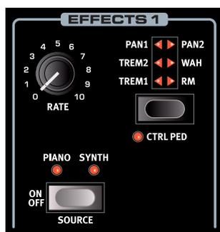
EFFECT1 ユニットには6種類のモジュレーション・エフェクトがあります。エフェクトの切り替えはセレクトター・ボタンで行い、[RATE]ノブを使用して選択したエフェクトのレート（速度）を設定します。
