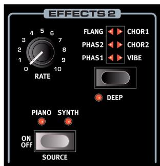
**EFFECT2**には、フェイザーとコーラス各2種類、フランジャーとヴァイブ・エフェクト各1種類を含むモジュレーション・エフェクトが用意されています。どのエフェクトも、エフェクト2の **[RATE]** ノブでエフェクトの周期をコントロールします。
