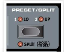
〔SHIFT〕 ボタンを押しながら〔SPLIT〕 ボタンを押すと、Nord Electro 3 の鍵盤が2つのセクション（ローとアッパー）に分割できます。ローとアッパーの境目（スプリット・ポイント）は初期設定値では B3 までがロー、C4 から上がアッパーになります。このスプリット・ポイントは〔SHIFT〕 ボタンと〔SPLIT〕 ボタンを押しながら（この間 LED が点滅しています）、分割したい位置の鍵盤を押して変更することができます。また、スプリット・ポイントはプログラムの一部として保存することが可能です。
