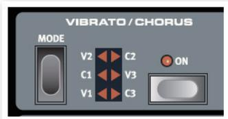
**B3** - オリジナルのトーンホイール型オルガンのビブラート / コーラス回路は、回転式スキャナーとディレイ・ラインの組み合わせにより実現していました。ビブラートにはフェイズ・シフターが信号にかかるように設計され、コーラスの場合はそのフェイズ・シフターにモジュレーションがかかって原音に付加される仕掛けになっていました。ビブラート、コーラスにはそれぞれ3種類のタイプ（V1 ~ V3, C1 ~ C3）があります。
