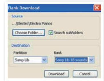
ダウンロード先（Destination）のドロップ・ダウンで「All」を選択すると、パーティション内のすべてのサウンドをダウンロード元（Source）のフォルダの階層構造のまま Nord Electro 3 にダウンロードされます。また、「Search Subfolder」にチェックが入っている場合、階層構造がすでに作られているフォルダのトップ・フォルダを選択することができます。
