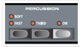
パーカッションのエンベロープ・ジェネレーターはシングル・トリガーのノン・レガート構成になっています。つまり、音が鳴っていない状態から最初に鍵盤をヒットした時のみ、パーカッションの音が出るということです。例えば、単音もしくはコードを弾いている時に、その弾いている鍵盤から手を離さずに別の鍵盤をヒットしても、その新たに弾いた音にはパーカッションがかからないということです。すべての音にパーカッションがかかるようにするには、次の音を弾く前に鍵盤から手を離す必要があります。つまり、レガート奏法をしないということです。
