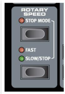
〔STOP MODE〕 ボタンを押すと、ロータリーが停止した状態を再現します。これはロータリー・スピーカー・エフェクトがオフになるのではなく、ロータリーが停止している状態のエミュレーションです。またこの時に〔SLOW/STOP〕 ボタンを押すと、ロータリーの回転がファストのスピードに加速します。これは、回転スピードがファストしかなかった初期のロータリー・スピーカーの動作を再現したものです。
