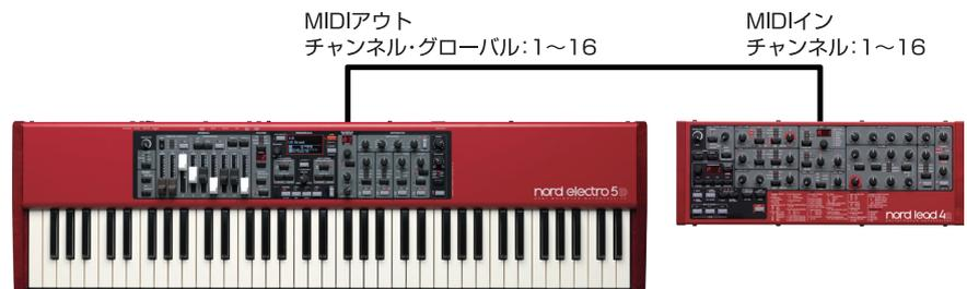
**MIDI接続:** Nord Electro 5の(MIDI OUT)端子と外部音源モジュールのMIDI IN端子を5ピン仕様のMIDIケーブルで接続します。
