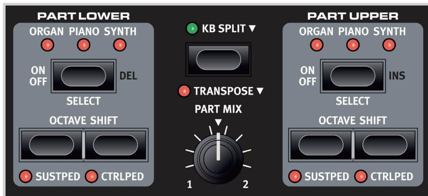
各パートはプログラム・エリア(上図)で選択でき、それぞれの音量バランスは〔PART MIX〕ノブで調整できます。また、KB SPLIT(キーボード・スプリット)モードの場合は鍵盤を2つのエリアに分割し、左手側がローワー、右手側がアッパーになります。鍵盤を2つのエリアに分割する位置(スプリット・ポイント)の設定は、〔KB SPLIT〕ボタンを押しながら〔VALUE〕ダイヤルを回して6カ所のスプリット・ポイント(C3、F3、C4、F4、C5、F5)から選択します。この時、フロント・パネル最下部(鍵盤の近く)でLEDがグリーンに点灯している位置がスプリット・ポイントです。
