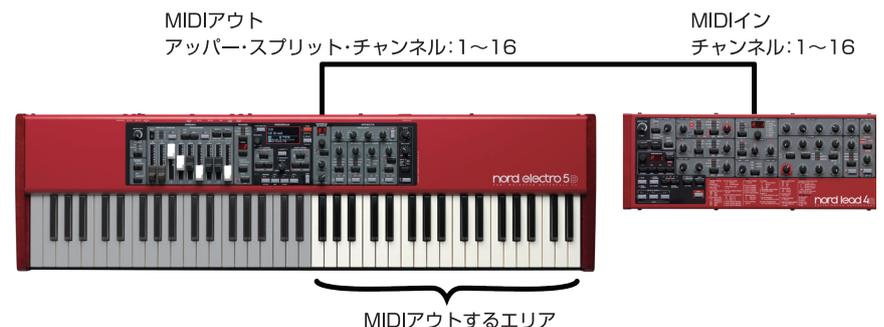
**MIDI接続:** Nord Electro 5の(MIDI OUT)端子と外部音源モジュールのMIDI IN端子を5ピン仕様のMIDIケーブルで接続します。
