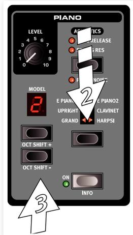
パネル上のパラメーターをエディットすると同時に、ディスプレイに表示されている音色名の後ろにアスタリスク(\*印)が表示されます。
