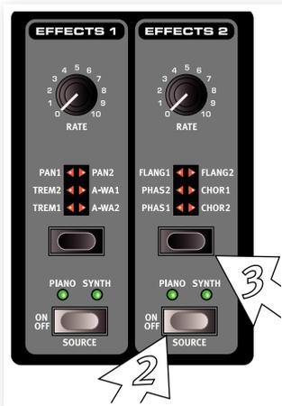
セレクトター・ボタンを押すたびに、エフェクト・タイプのLEDが時計回りに巡り回して点灯し、エフェクトの種類が切り替わります。
